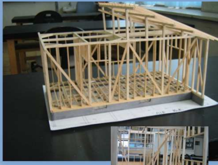
◆住宅模型 木造建築物の基礎を学ぶ。
